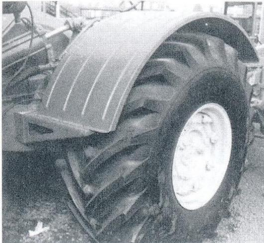
*Bild 3.79 Sicken- und Bördelversteifung eines Kotflügels*
